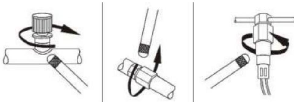
Visualmente examine o Sistema de refrigeração. Os pontos oleosos e sujos, soldas, porcas de junções das válvulas, conexões em geral são as áreas mais propícias a vazamentos de gases;
